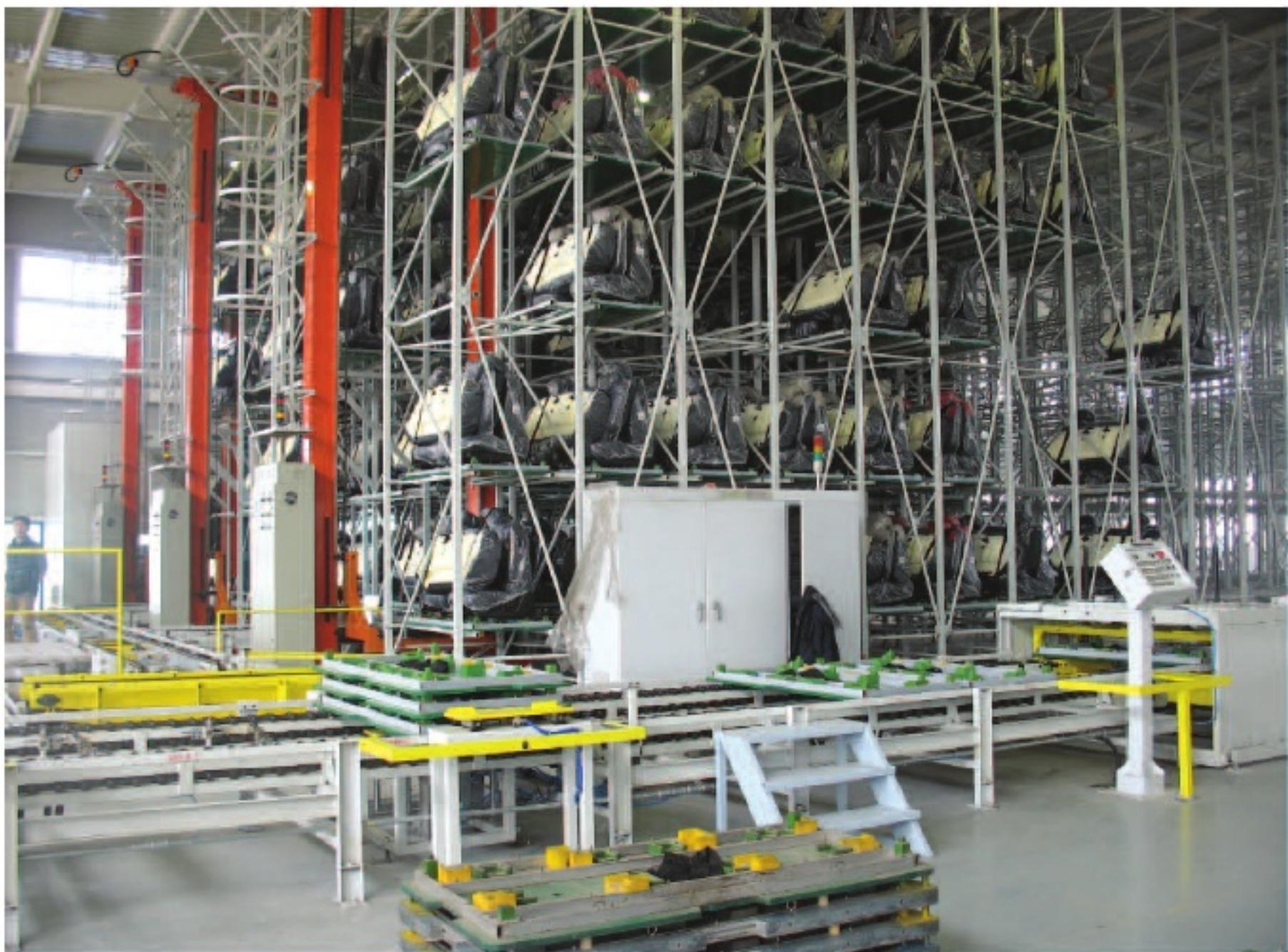
自动化立体仓库是现代物流系统中迅速发展的一个重要组成部分，它具有节约用地、减轻劳动强度、消除差错、提高仓储自动化水平及管理水平、提高管理和操作人员素质、降低储运损耗、有效地减少流动的积压、提高物流效率等诸多优点。
